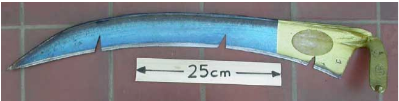
Abbildung 2. Die drei Kerben im Sensenblatt entstanden durch die Entnahme der kleinen Proben für die Härteprüfung. Jede Probe wurde in Kunststoff eingesetzt, um den Schneidenquerschnitt sichtbar zu machen, der anschließend mit 1 \mu\text{m} Diamantpaste poliert wurde. Die Härteeindrücke wurden dann auf diesen vorbereiteten Proben gemacht. Die Proben wurden mit 1, 2 und 3, beginnend bei der Sensenhamme, am Bild von rechts nach links, durchnummeriert.
